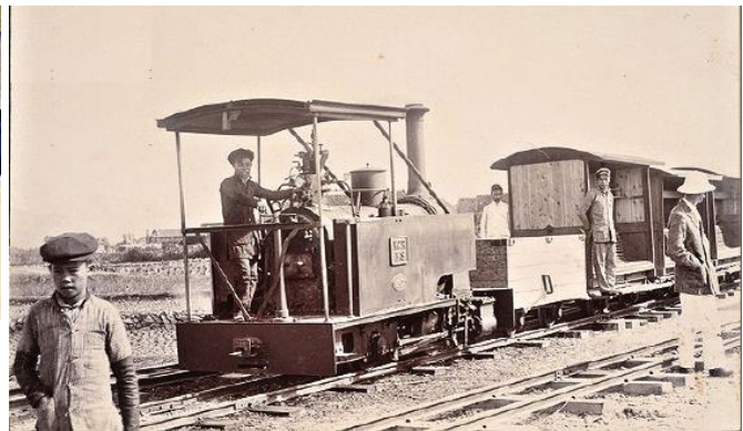
沙頭角鐵路通車初期所用的窄軌蒸氣火車頭，新建的車廂則只設兩排背靠背的座位。 (夢周文教基金會藏品)
